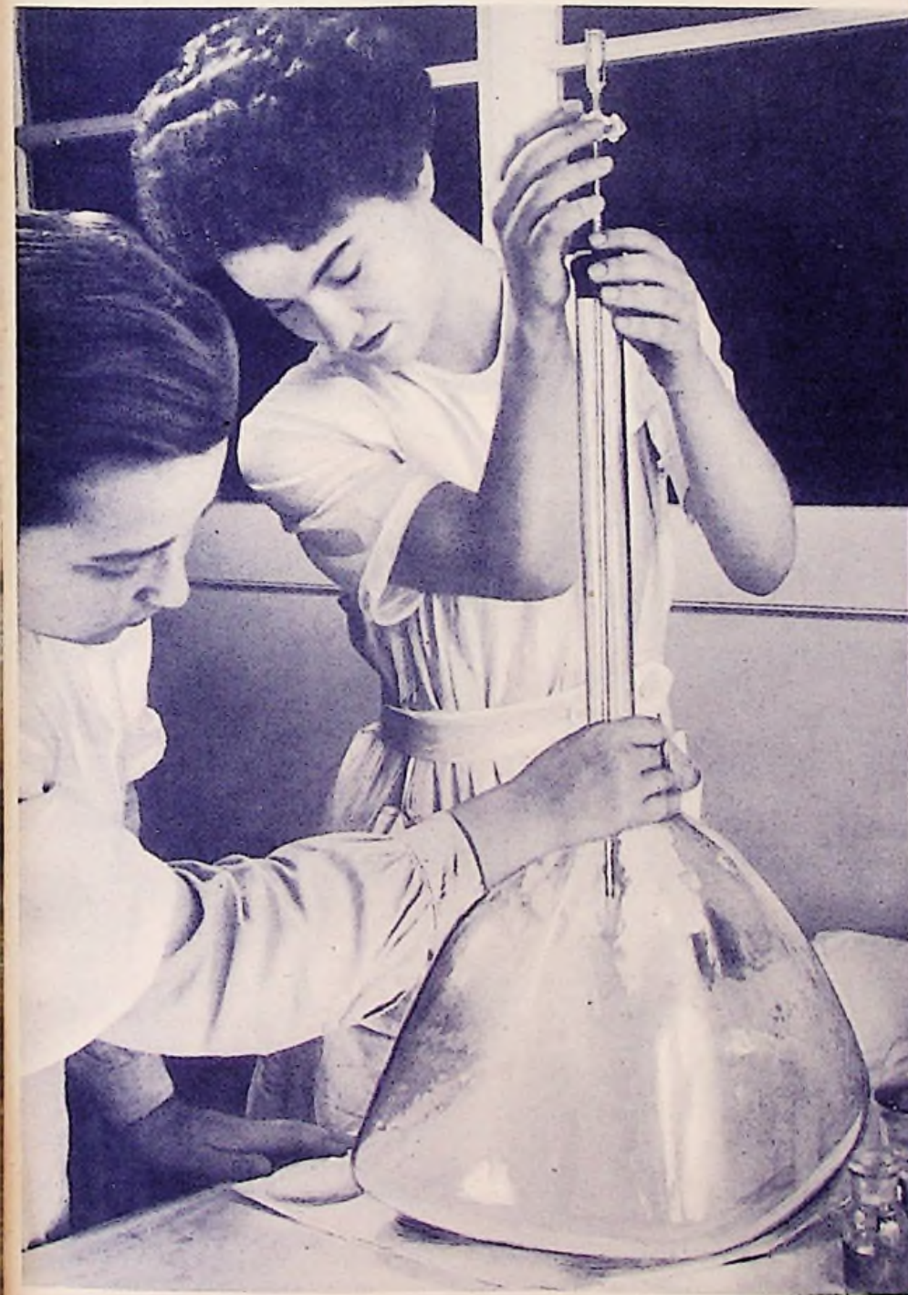
Eine beinahe heilige Handlung stellt das Auftropfen der Kollodium-Lösung auf die Wasseroberfläche im Bildröhrenkolben dar. Es ist dies einer der wichtigsten Arbeitsvorgänge bei der Herstellung metallisierter Bildröhren. (Aufnahme aus der Röhrenfabrik der Loewe-Opta AG: E. Schwahn)
