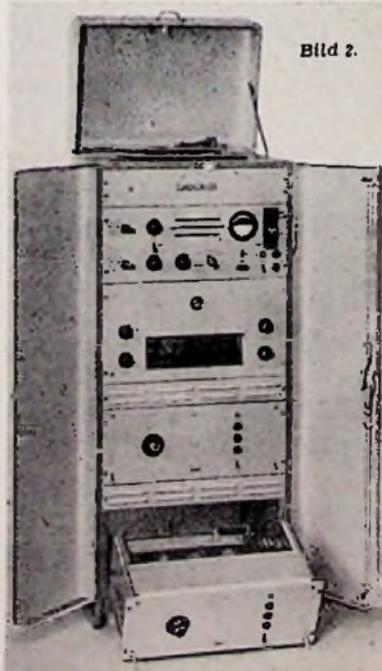
Als Rundfunkempfänger ist jedes normale Gerät zu verwenden; es wird aus seinem Gehäuse herausgenommen und auf dem Empfängerreinschub der Verstärker-Zentrale montiert. Normalerweise arbeitet die Zentrale mit dem Lorenz-Super „München“.
