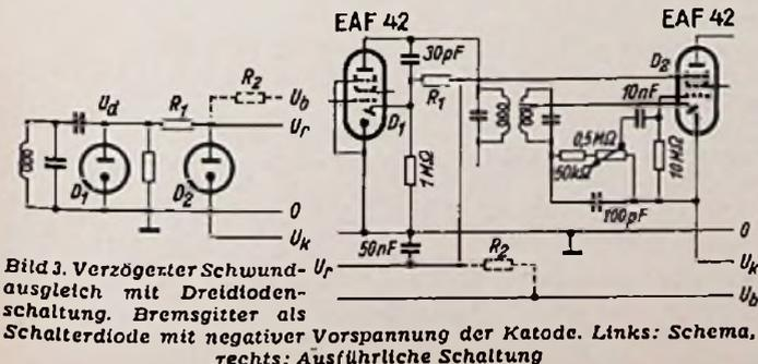
Bild 3. Verzögerter Schwundausgleich mit Dreiodenschaltung. Bremsgitter als Schalterdiode mit negativer Vorspannung der Katode. Links: Schema, rechts: Ausführliche Schaltung
