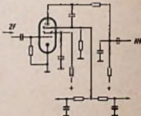
verbleibende Zwischenfrequenzspannung wird im Bremsgitterkreis gleichgerichtet und dient als Schwundregelspannung und für die Abstimmanzeigeröhre.
