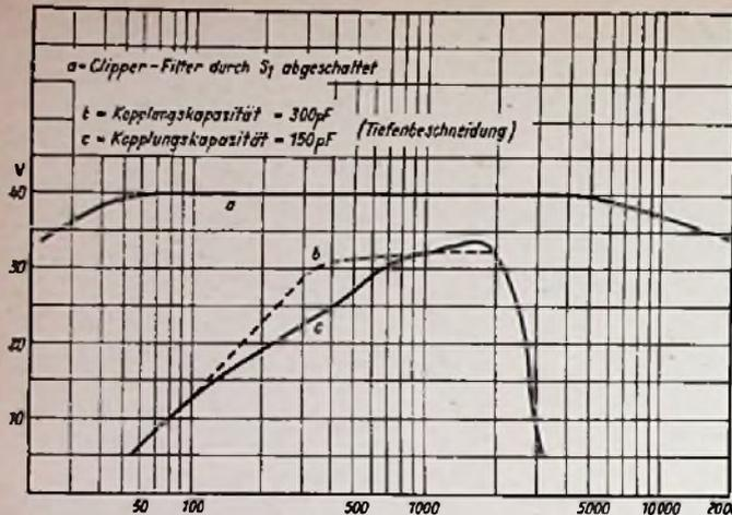
Bild 5. Frequenzkurven des Clipper-Filters bei verschiedenen Kopplungskapazitäten
