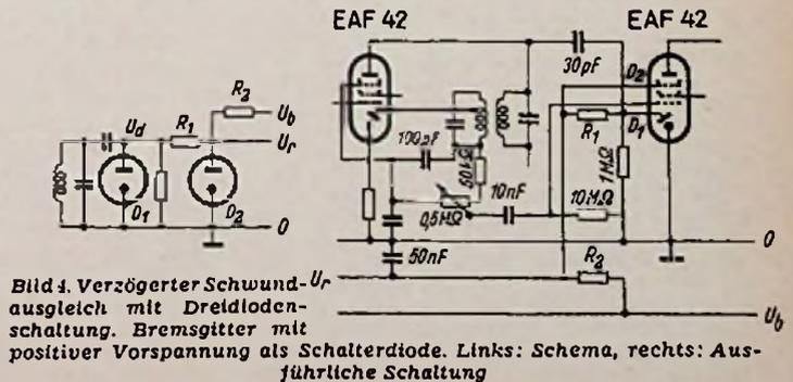
Bild 4. Verzögerter Schwundausgleich mit Dreiodenschaltung. Bremsgitter mit positiver Vorspannung als Schalterdiode. Links: Schema, rechts: Ausführliche Schaltung
