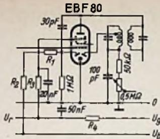
**Bild 6. Schaltung nach Bild 5 mit einer Röhre**
