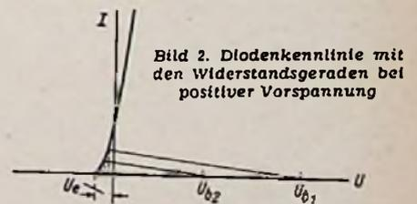
Bild 2. Diodenkennlinien mit den Widerstandsgeraden bei positiver Vorspannung
