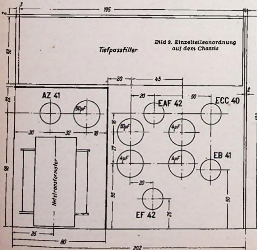
Bild 9. Einzelteilanordnung auf dem Chassis
