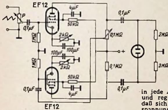
Bild 77. Schaltung zur elektrostatischen Strahlableitung
