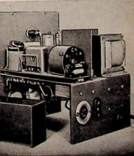
Oben: Bild 1. Rückansicht mit abgeschirmter Mikrophon-Eingangsbuchse (Tuchel) und Ausgangsbuchsenpaar
