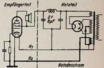
tauscht (Bild). Der Kathodenstrom mußte somit die Heizwicklung durchlaufen und wurde von der 4-Volt-Heizspannung beeinflusst, so daß hierüber über diesen Weg eine Brummspannung in den Empfangsteil gelangen konnte.
