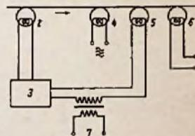
Zur Mischung mit anderen Geräuschen, zur Korrektur des Frequenzgangs und der Dynamik oder des Nachhalls wird die Tonaufnahme durch 2 (Bild) abgetastet, in 3 verstärkt, mit 7 gemischt und nach Löschern mit Hilfe von 4 durch 5 dem Tonträger aufs neue aufgeprägt. Über 6 kann dann die geänderte Aufnahme abgenommen werden.
