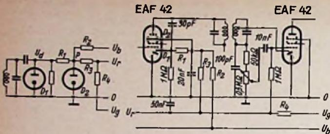
**Bild 5. Verzögerter Schwundausgleich mit Dreiodenschaltung. Bremsgitter mit positiver Vorspannung als Schalterdiode. Grund-Gittervorspannung über Spannungsteiler. Links Schema, rechts: Ausführliche Schaltung**
