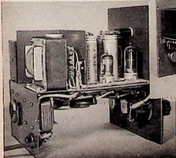
Unten: Bild 4. Rückansicht des Clipper-Filters bei abgenommener Abschirmhaube des Tiefpaßfilters
