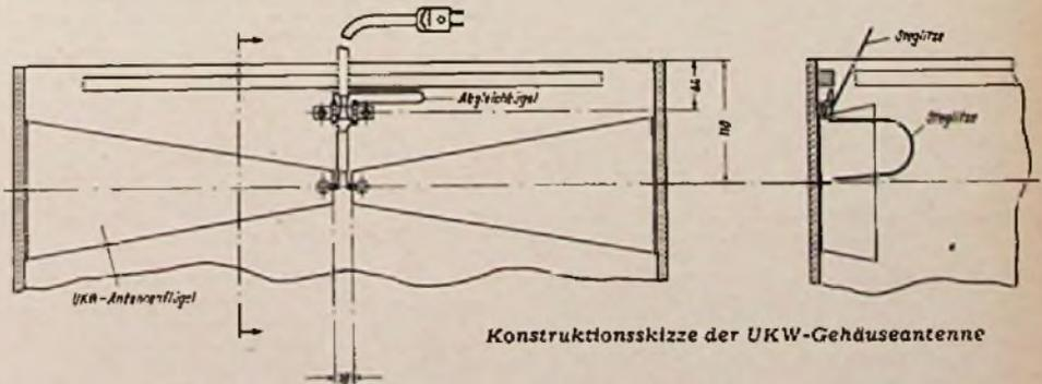
Konstruktions-skizze der UKW-Gehäuseantenne
