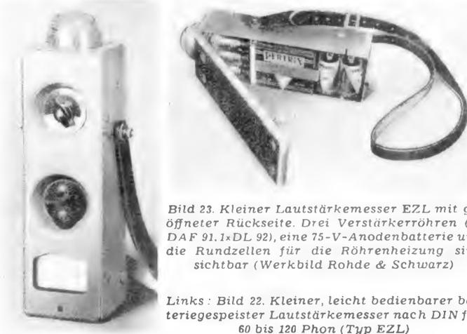
Bild 23. Kleiner Lautstärkemesser EZL mit geöffneter Rückseite. Drei Verstärkeröhren (2x DAF 91.1x DL 92), eine 75-V-Anodenbatterie und die Rundzellen für die Röhrenheizung sind sichtbar (Werkbild Rohde & Schwarz)
