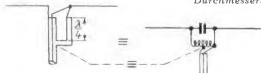
Bild 9. Ersatzschema für eine Symmetrierleitung
