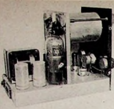
Bild 5. Innenansicht: Die vordere Röhre ECC 40 wurde entfernt, um das elektrisch günstig zwischen den beiden Röhrenfassungen angeordnete Tandempotentiometer zu zeigen
