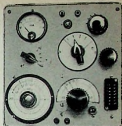
Bild 2. 80-m-Sender im Gehäuse, Frontplattenansicht. Oben links: Anodeninstrument, Mitte: Antennenausgang und Indikatorlampchen, rechts oben: Antennenschalter. Mitte links: Modulationsgrad-Potentiometer, Mitte: Endstufenabstimmung, rechts: Stimmabstimmung (Einspeifen). Unten links: Oszillatorabstimmung, Mitte: Verdopplerabstimmung, Anschlußsteckerleiste
