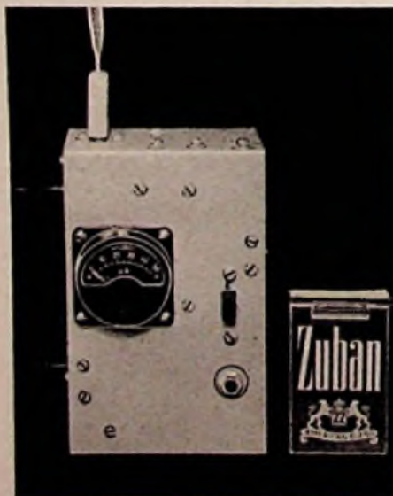
Bild 1. Meßteil der UKW-Wünschelrute. An der Frontplatte befinden sich das Meßinstrument mit Umschalter und der Regler für Ruhestromkompensation. Die Abmessungen des Kästchens betragen 145 x 92 x 65 mm
