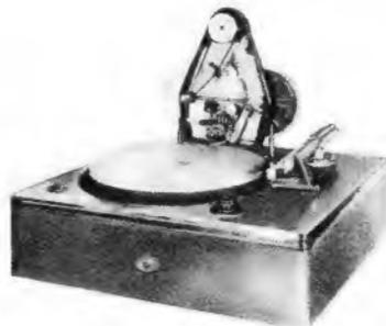
Bild). Der Antrieb für das abzuspielende Band erfolgt vom Plattenteller aus und ist für Bandgeschwindigkeiten von 19 und 38 cm/sek umschaltbar. Die Frequenzkurve des Hörkopfes reicht bis 15 000 Hz. hgm
