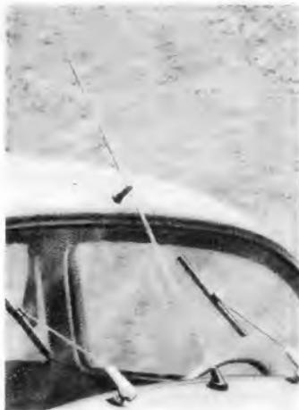
belsee und 9,6 mm für den Mantel. Kapazität einschließlich Kabel in montiertem Zustand wenig mehr als 45 pF. Antennenfuß und Stütze in Stromlinienform, aus neuartigem Kunststoff bestehend, der weder splittert noch bricht und eine klapperfreie Halterung garantiert. Das untere Antennenrohr wurde möglichst dünn gestaltet, um die Sicht bei Montage in der Mitte der nicht geteilten Windschutzscheibe nur wenig zu beeinträchtigen. Hersteller: Richard Hirschmann, Esslingen/N.
