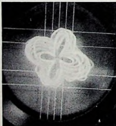
Bild 8. Peildiagramm von zwei gleichzeitig arbeitenden Sendern
