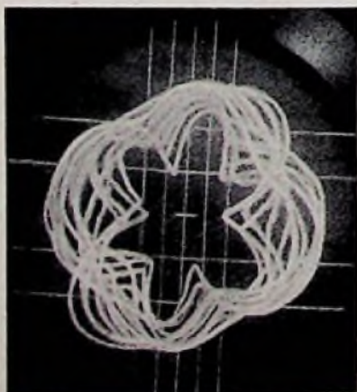
Bild 9. Peildiagramm von drei gleichzeitig arbeitenden Sendern
