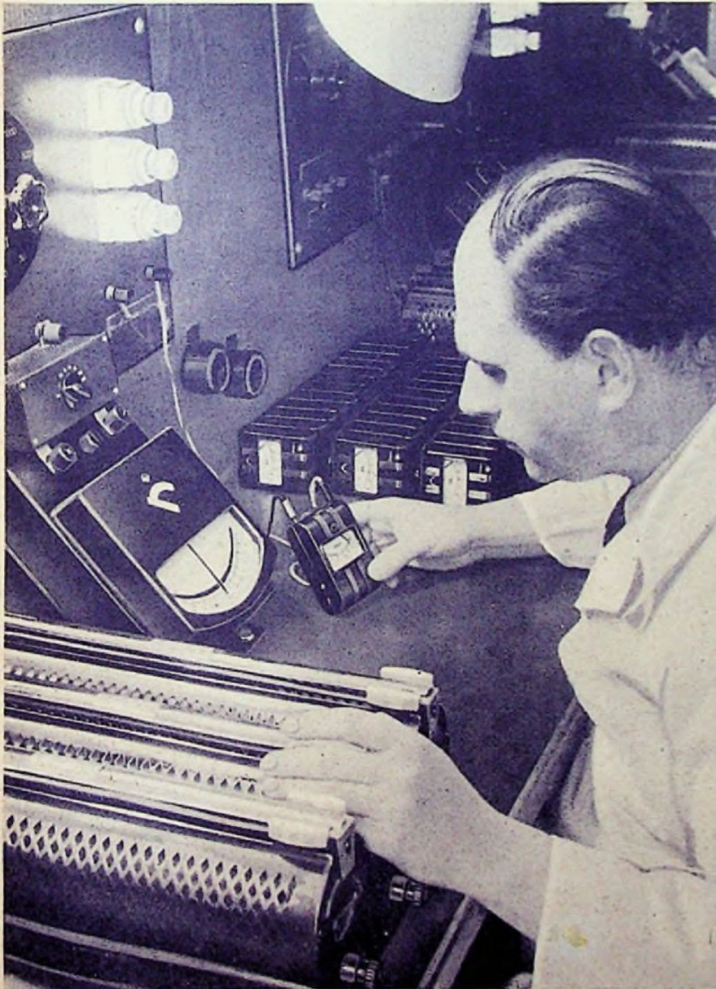
Die Meßgeräte-Industrie nimmt die Abgleichung von Ohmmetern mit besonderer Sorgfalt vor, da hiervon die Genauigkeit der Messungen in vielen Werkstätten abhängt. Unser Bild zeigt den Abgleichvorgang des Trlohm, eines bekannten Ohmmeters, das in großen Stückzahlen gefertigt wird. (Werkfoto: P. Gossen)
