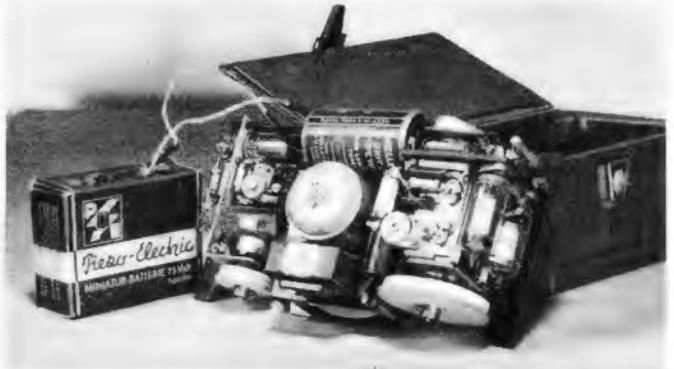
Bild 6. Chassisansicht des betriebsfertigen Reisesupers
