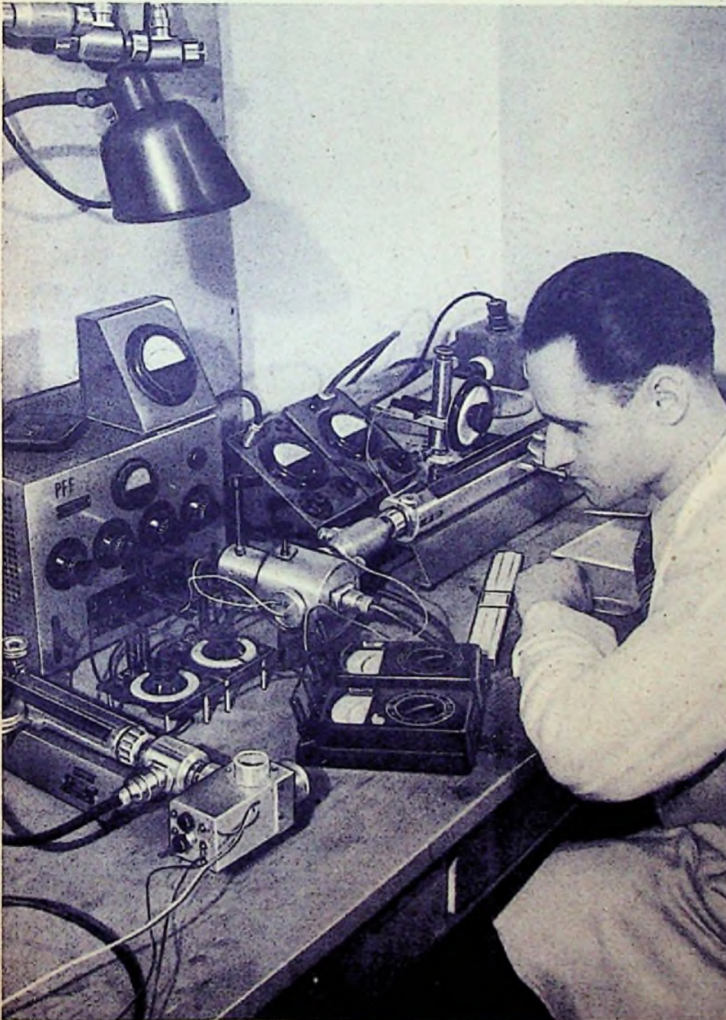
Messung des Eingangswiderstandes eines Dezimeter-Verstärkers mit Hilfe einer Meßleitung und eines Durchgangsvoltmeters im Dezimeterwellen-Labor von Rohde & Schwarz, München.
