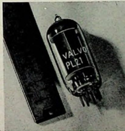
Bild 5. Thyatron 2) oder Stromtor PL 21 für einen maximalen Anodenstrom (Mittelwert) von I = 0,1 A und einen maximalen Scheitelwert der Sperrspannung von \hat{U}_{max} = 500 V. Größte Länge 54 mm
