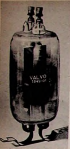
Links: Bild 7. Thyatron PL 150 für einen maximalen Anodenstrom (Mittelwert) von I = 15 A und einen maximalen Scheitelwert der Sperrspannung von \hat{U}_{\max} = 500 V. Größte Länge 291 mm
