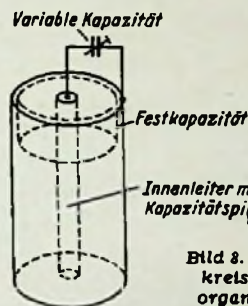
Bild 8. Topfkreis mit organischer eingebaute Festkapazität und außen angeschlossener variabler Kapazität
