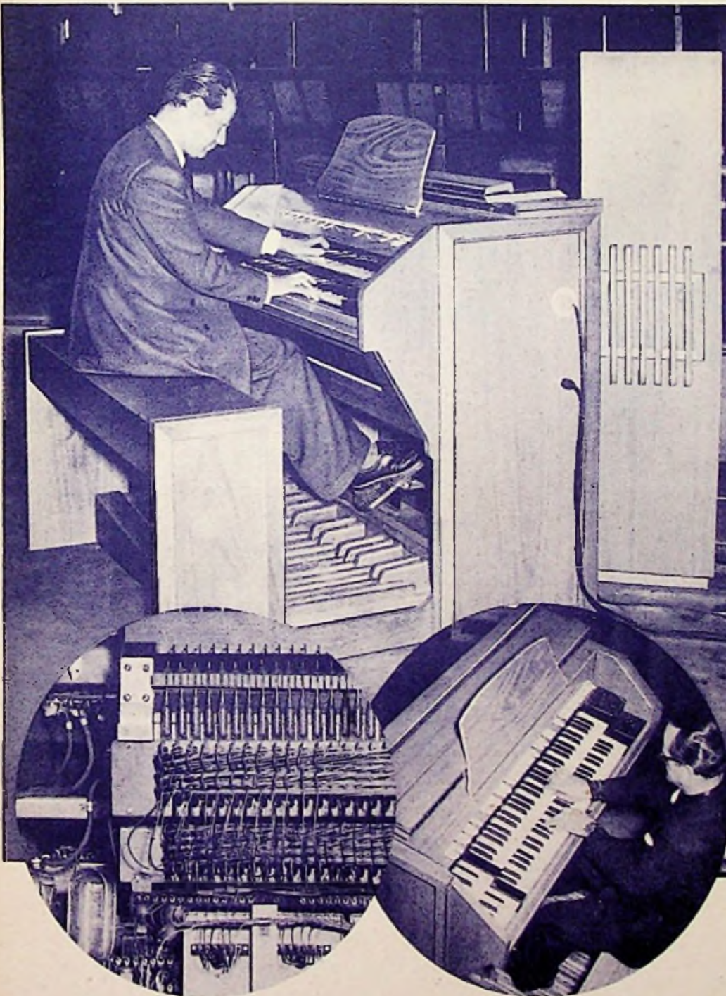
Harald Bode, einer der bekanntesten Fachleute auf dem Gebiet der elektrischen Musik, führt seine neue Elektronenorgel „Polychord“ vor. Der Spieltisch und die Klangmöglichkeiten entsprechen vollkommen einer normalen Pfeifenorgel, die Konstruktion sichert eine wirtschaftliche Herstellung, so daß große Absatzmöglichkeiten, besonders im Export, bestehen. — Links unten ein Teil der Kreuzschienenverteller zur Synthese der verschiedenen Klangfarben. (Aufnahme: C. Stumpf)
