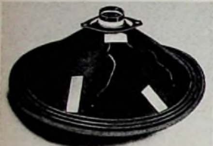
Bild 2. Das Festlegen der Anschlußenden der Spulungsspule und das Kleben von leichten Rissen in der Membrane durch Tesaflexstreifen
