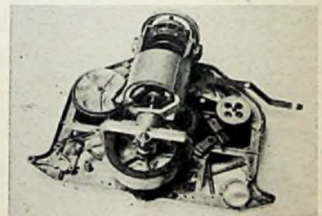
Bild 2. Antriebsmechanismus des AEG-Magnetophons KL 15
