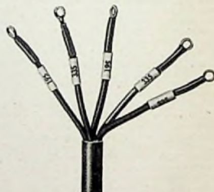
Bild 6. Kennzeichnen von Kabeladern und Kabelschuhen durch Tesadur-Bezeichnungsbänder
