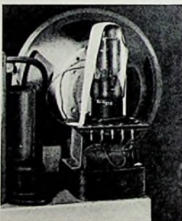
Bild 5. Das Sichern der Röhren für den Transport durch Überkleben mit Tesakrepp
