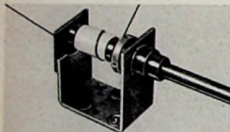
Bild 3. Die Tesaflex-Bandage verhindert das Rutschen des Skalenseiles
