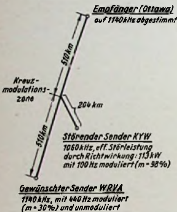
Bild 2. Versuchsstrecke, auf der vom 6. bis 10. Juni 1950, jeweils um 2 Uhr nachts, Versuchsendungen zur Klärung des Luxemburg-Effekts durchgeführt wurden. Der gewünschte Träger wurde durch den Störsender zu 0,6...0,75% moduliert
