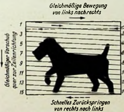
Bild 2. Abtasten eines ebenen Bildes zur elektrischen Übertragung
