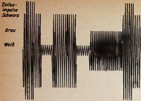
Links: Bild 14. Hochfrequentes Fernsehsignal, moduliert mit dem Bildinhalt der Zelle a aus Bild 9
