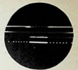
Bild 6. Impulsschema der Fernsehnorm (etwa 3% der Bildperiode), wie es auf dem Bildschirm des Grundig-Fernsehoszillografen erscheint
