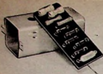
Bild 7. Praktisches Aufbaubeispiel für einen Radiodetektor nach Bild 6
