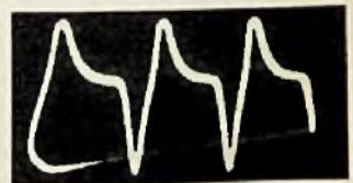
Bild 120. Oszillogramm der differenzierten Spannung
