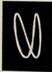
Bild 115. Phaselage zwischen synchronisierender und synchronisierter Spannung
