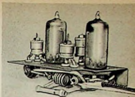
Bild 1. Gesamtansicht einer UKW-Baueinheit mit Hf-Vorstufe und Mischröhre
