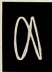
Bild 116. Wie Bild 115, andere Phaselage bei nachgeregelter Frequenz
