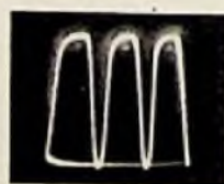
Bild 119. Oszillogramm der Spannung am Anodenwiderstand
