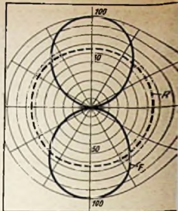
Rechts: Bild 3. Richtdiagramm der Ringantenne R und eines normalen Faltdipols F
