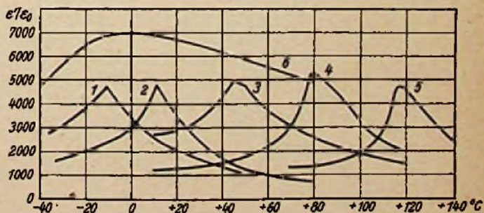
Bild 1. Abhängigkeit der Dielektrizitätskonstanten verschiedener Stoffe von der Temperatur.
