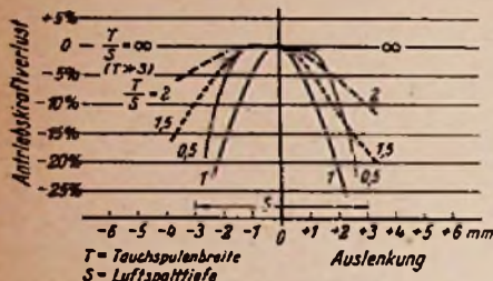
Bild 3 Einfluß verschieden breiter Schwingspulen. T = Tauchspulenbreite; S = Luftspalttiefe
