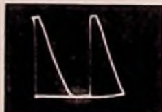
Bild 134. Anodenstromverlauf der 6L6 bei ohmschem Außenwiderstand
