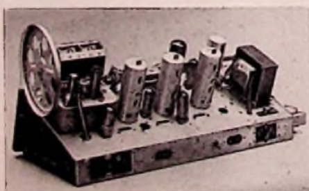
Bild 3. Schräges Chassis des Krefft W 529 mit seitlicher Seilscheibe des Drehkondensators
