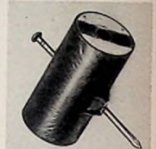
Bild 4. MP-Kondensator mit unter Spannung durchgeschlagenem Nagel. Der Kondensator blieb voll betriebsfähig
