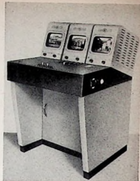
Bild 6. Mischpult zur Auswahl bzw. Mischung und Überblendung der von verschiedenen Aufnahmegerten angelieferten Fernseh-Bildsignale
