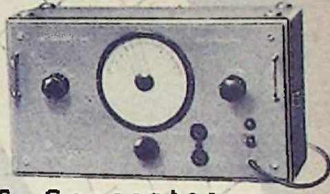
RC - Generator Type SRM Frequenzbereich 30 Hz ... 300 kHz (dekodisch unterteilt) Klirrfaktor (k) . . . . . < 1 %
