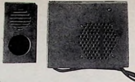
Bild 2. Mikrofon und Rückmeldeleuchte (kleines Küstchen) und Verstärkerleinheit des Hartres-Überholmeldegerätes (Versuchsausführung)
