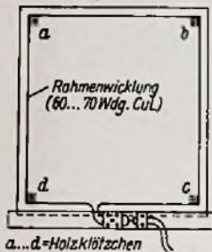
Bild 2. Die Rahmenwicklung wird an der Rückwand eines 18 x 24 cm großen Fotofrahmens angebracht
