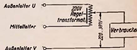
und einem Außenleiter des 220/380 V-Drehstromnetzes angeschlossen. Zwischen einem weiteren Außenleiter und dem Abgriff des Regeltransformators lassen sich dann 220 bis 380 V entnehmen. Bei dieser Anordnung wird mit dem 220-V-Transformator nur eine Spannungsdifferenz von 160 V überschritten. Die Einstellung ist deshalb feinstufiger als sonst. Bei geerdetem Mittelleiter des Drehstromnetzes darf der Verbraucher nicht geerdet werden!
