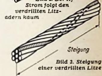
Bild 3. Steigung einer verdrillten Litze
