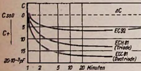
Bild 3. Kapazitäts-Änderung verschiedener Röhren während der Einlaufzeit
