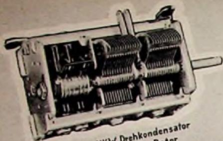
Kombinierter UKW Drehkondensator
