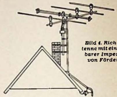
Bild 4. Richtantenne mit einstellbarer Impedanz von Förderer
