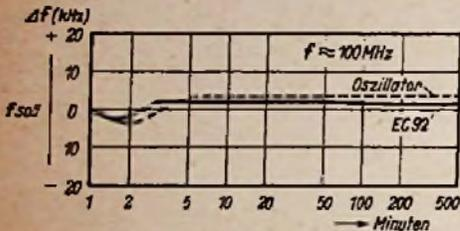
**Bild 7.** Frequenzverlauf bei einer richtig durchgeführten Kompensation
