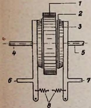
**Bild 1.** Prinzip der Kupplungswaage von Siemens. 1 = Schwingungsmasse, 2 = Kupplungsbelag, 3 = Kupplungsscheibe, 4 = Antriebsachse für KML, 5 = UKW-Antriebsachse, 6 = zu den Tasten KML, 7 = zur UKW-Taste
