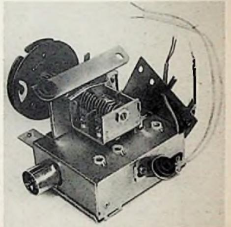
Bild 9. Abgeschirmter Graetz-UKW-Oszillator mit der Röhre EC 92
