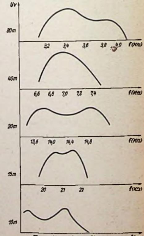
Bild 4. Spannungskurven eines Bandfilter-Steuersenders
