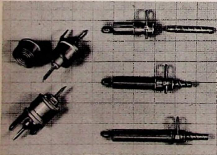
Bild 3. Philips-Lufttrimmer (30 pF) und keramische Rohrtrimmer (5, 10, 18 pF)
