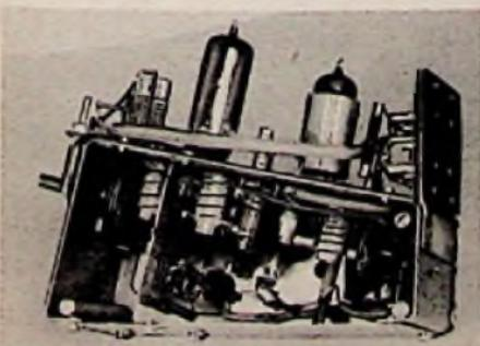
Bild 11. Der geöffnete UKW-Baustein von Loewe-Opta mit Dreifach-L-Abstimmung
