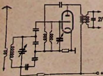
**Bild 8.** Selbstschwingende Triodenmischschaltung
