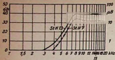
Bild 7. Schalldruckkurve bei LC-Ankopplung, Mikrofonabstand 1 m
