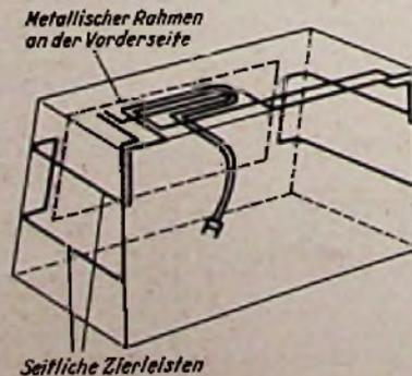
**Bild 3.** Zwillingsantenne unter Verwendung der Metallbeschläge (Grundig)
