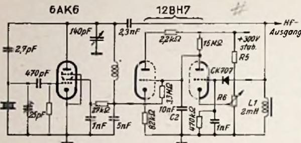
Schaltung zur Amplitudenstabilisierung eines Hf-Oszillators
