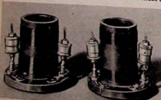
Links: Bild 2. Bandfilter für Steuer-sender
