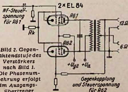
Bild 2. Gegentaktendstufe des Verstärkers nach Bild 1. Die Phasenumkehrung erfolgt im Ausgangsübertrager
