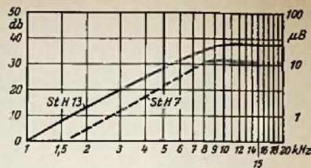
Bild 9. Schalldruckkurve bei RC-Ankopplung, Mikrofonabstand 1 m
