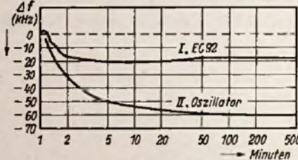
Bild 2. Frequenzänderung des Oszillators
