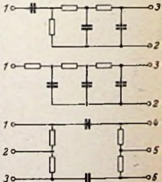
Bild 4. Beispiele von kombinierten Schaltelementen, wie Integrationsglieder in Fernsehempfängern und Diodenfilter für Ratiodetektoren
