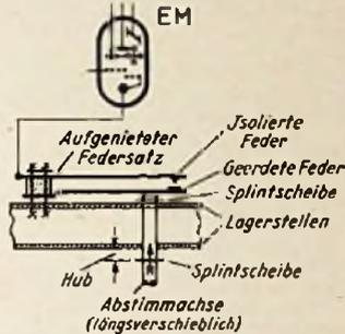
Mit Hilfe eines Federsatzes in der Katodenleitung des Magischen Auges wird die Spannung nur während des eigentlichen Abstimmvorganges angelegt. Die Abstimmachse wird zu diesem Zweck eingedrückt.
