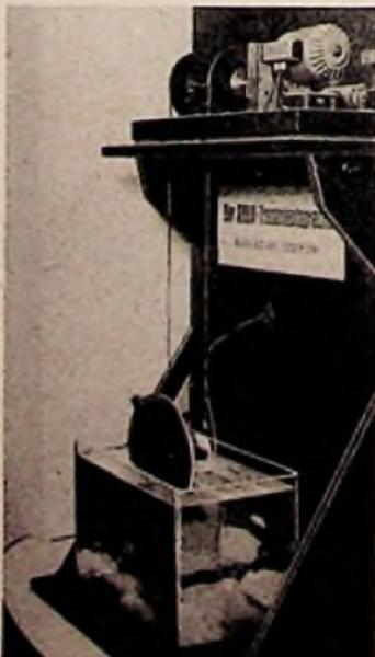
Die Wasserfestigkeit wurde sehr eindrucksvoll an einem Demonstrationsstück bewiesen, das auf der Hannoverschen Messe ausgestellt war. Ein Uhrwerk tauchte einen tropfenfest imprägnierten Lautsprecher in ein Wasserbassin ein und hob ihn nach einigen Sekunden wieder heraus. Obgleich das Wasser aus dem System herauslief, war die Tonwiedergabe völlig klar. Durch die direkte Feuchtigkeitseinwirkung war weder Membran noch deren Zentrierung beschädigt worden.
