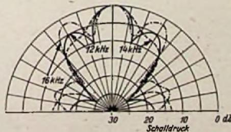
Bild 3. Richtcharakteristik der hohen Frequenzen beim 9770 FM
