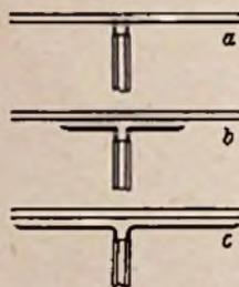
Bild 1. Änderung des Anpassungswiderstandes eines einfachen Dipolstabes durch Versetzen der Kabelenden.
