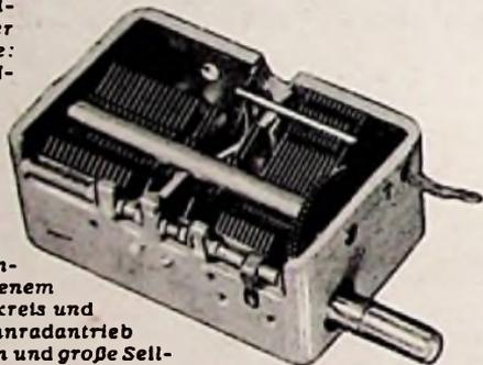
Bild 2. Zweifach-AM/FM-Drehkondensator mit Zahnrad-Antrieb und verschiedenem Plattenschnitt für AM-Vorkreis und -Oszillator (Philips). Der Zahnradantrieb erspart hohe Übersetzungen und große Seilräder bei der eigentlichen Antriebskonstruktion
