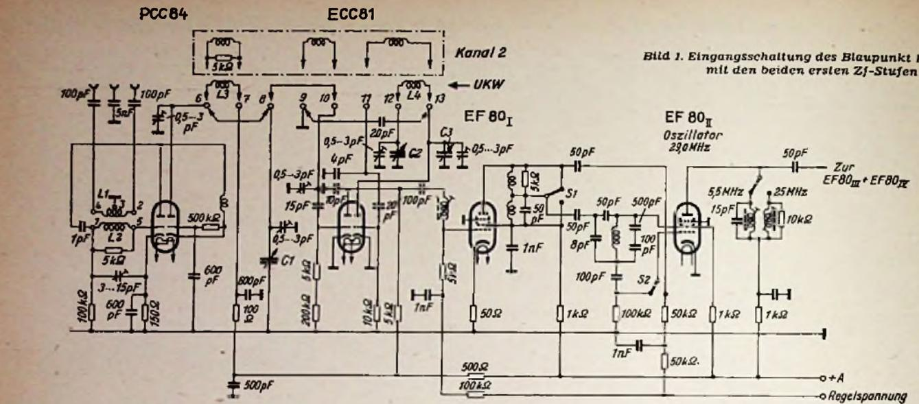
Bild 1. Eingangsschaltung des Blaupunkt P 2053/3053 mit den beiden ersten Zf-Stufen
