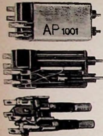
Bild 1. Philips-Mikro-Bandfilter. Oben: AM-Bandfilter AP 1001 im Gehäuse; Mitte: ohne Gehäuse; Unten: FM-Mikro-Bandfilter ohne Gehäuse. Hohe Güte sowie Temperaturfestigkeit bis +80°C sind weitere Kennzeichen dieser Kleinbau-Teile
