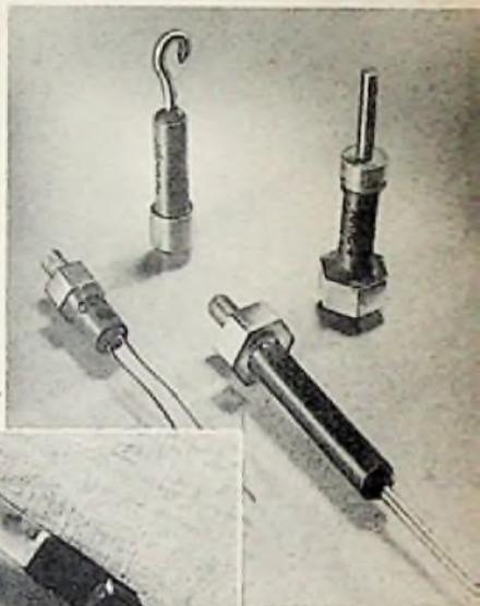
Bild 2. UKW-Flachkondensatoren (Rosenthal)
