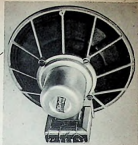
Bild 4. Körting-Lautsprecher mit neuartigem Korb
