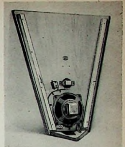
Bild 11. Cefophon-Schallecke, Rückansicht einer Eckenlautsprecherkombination von Lorenz
