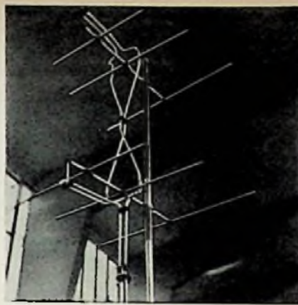
Bild 2. Fuba-Breitband-Antennen mit „Resonanz-Kompensatoren“ (Hans Kolbe & Co)
