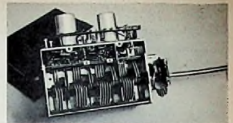
Bild 3. Der kontaktlose Kanaltwähler mit L-Abstimmung von Körting (Abschirmwände entfernt)
