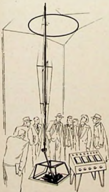
Die balancierende Stange. Ein Schaubildspiel für die Möglichkeiten der Elektronik. Mit Hilfe von Siemens-Zelgerreglern ZR 5 wird der untere kurze Hebelarm so gesteuert, daß die Stange stets unterhalb ihres Schwerpunktes unterstützt wird. Sie wird dadurch senkrecht stehend balanciert, wie durch einen geschickten Jongleur
