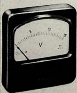
Röhrenprüfgeräte, Röhrenvoltmeter usw., eingebaut. Die Flanschgröße beträgt 88 X 72 mm. Das Instrument wird als Voltmeter und Milliampereometer geliefert. Die empfindlichsten Typen besitzen 10 mV, bzw. 10 µA Vollausschlag. Hersteller: P. Gosens & Co. GmbH, Erlangen.
