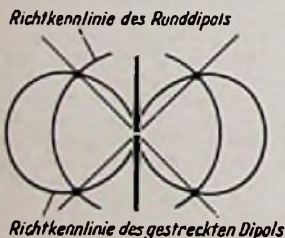
Bild 8. Vergleich zwischen Runddipol und gestrecktem Dipol
