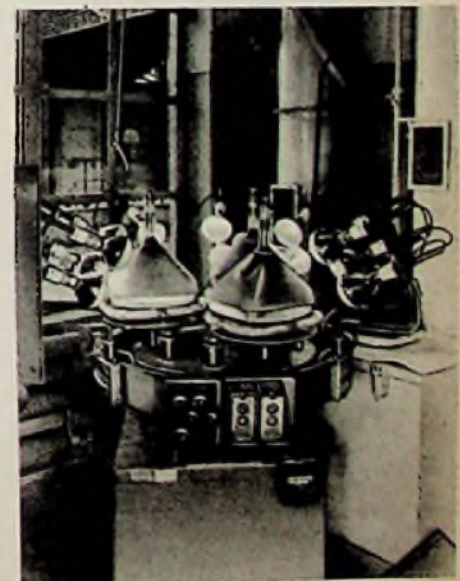
Bild 3. Aus der Bildröhrenfertigung: der äußere, leitende Überzug der Bildröhre wird mit Infrarotstrahlern getrocknet
