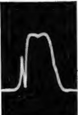
Bild 10. Gesamtcurve eines Zf-Verstärkers am Oszillografen mit zu steilen Zacken nach dem Ton-saugkreis
