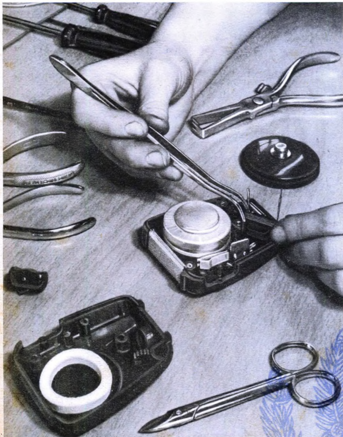
Der Bau von Tauchspulenmikrofonen erfordert neben der Beherrschung akustischer Gesetze eine gut durchgebildete Fertigungstechnik. Hier ein Ausschnitt aus der Montage eines Tauchspulenmikrofons Typ MD 5 vom Labor Wennebostel
