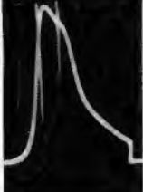
Bild 12. Die Kurve ist mit einem zu wenig gedämpften Kreis falsch nachgezogen worden. Die Frequenzmarken liegen ebenfalls bei 23 u. 26 MHz. Man erkennt die große Steilheit der linken Flanke
