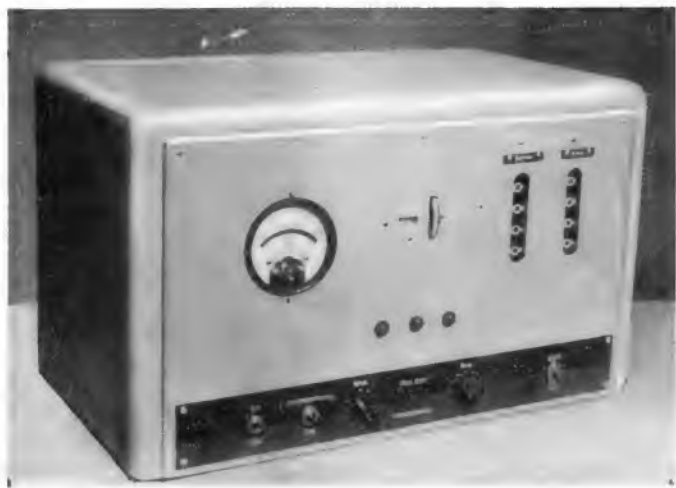
Bild 12. Ein industriell hergestellter Geiger-Müller-Zähler, (Ing. F. Schreib, Wien). In den schwarzen Schlitzen sind die Interpolations-Glimmlämpchen sichtbar
