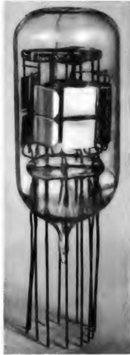
Bild 1. Außenansicht des achtstufigen Zweibahn-Sekundärelektronen-Vervielfachers
