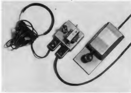
Bild 7. Morse-Übungsanlage mit Batterieröhrensummer nach Bild 6
