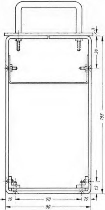
Oben: Bild 6. Zusammenbau des Chassis
