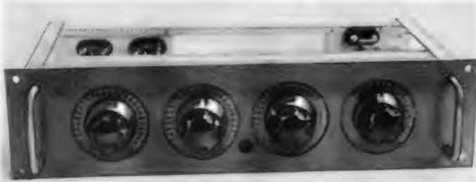
Bild 2. Vorderansicht des Gerätes. Von links nach rechts: Regler für die Kanäle 1+2, 2+3 sowie für Höhen- und Tiefeneinstellung
