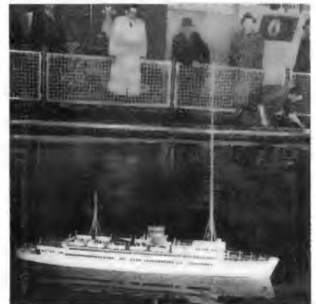
Das 1,20 m lange Modellschiff Tannenberg. Auf dem Vorschiff die Antenne für die Fernlenkanlage
