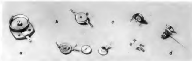
Bild 1. Keramiktrimmer. a = Hochspannungs-Scheibentrimmer, b = Kapseltrimmer (im Vordergrund Einzelteile des Kapseltrimmers), c = Kleinst-Scheibentrimmer mit Befestigungsfederblech (unten), d = Schraubtrimmer
