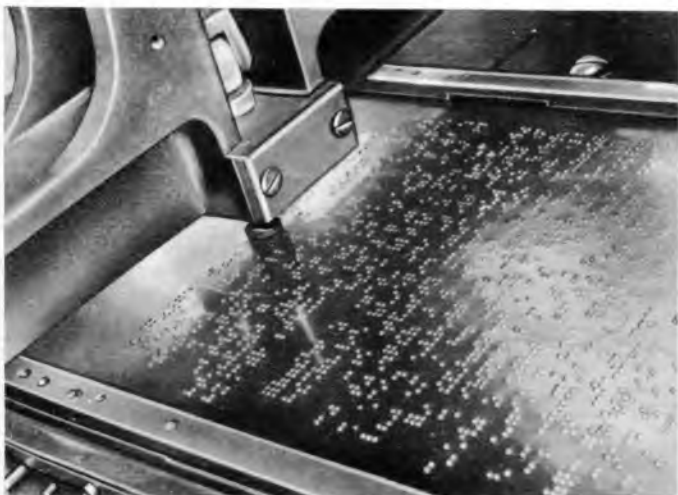
Herstellung einer Blindenzeitschrift. Die Buchstabengruppen werden in eine Zinkplatte eingepragt. Diese Platte dient dann zum „Drucken“ der eigentlichen Blindenzeitung
