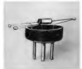
Bild 2. Transistor auf einen Röhrensockel montiert
