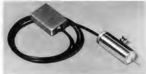
Bild 3. Ein Tastkopf mit Germaniumdiode zum Gleichspannungsvoltmeter gestattet auch das Messen von Hf-Spannungen
