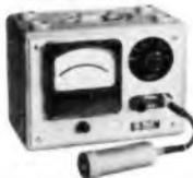
Hf-Tastvoltmeter 100kHz-300MHz, 10mV-10V
