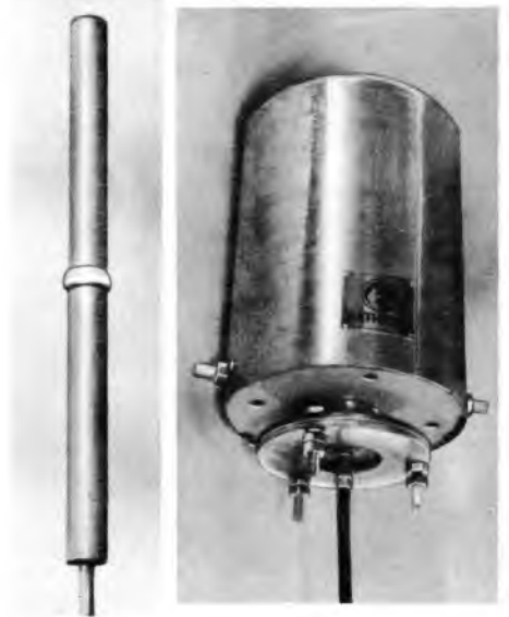
Links: Bild 3. Ansicht der in Bild 1 geschnitten dargestellten Kathrein-Sperrtopfantenne
