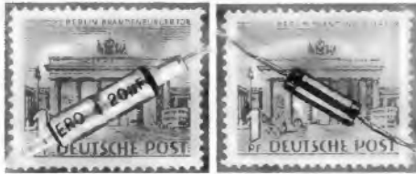
„Miniaturisierung“ von Bauteilen. Links ein „Minitytkondensator“ von Roederstein, rechts eine Entstördrossel der Stemag
