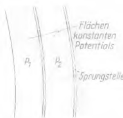
Bild 20. Unterteilung eines Potentialfeldes in Flächen konstanten Potentials
