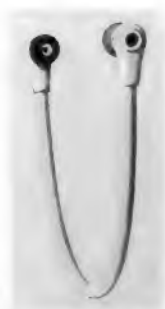
Hörbügel Stetoclip für beidohriges Hören. Die Hörerkapsel wird auf einer Seite aufgesteckt
