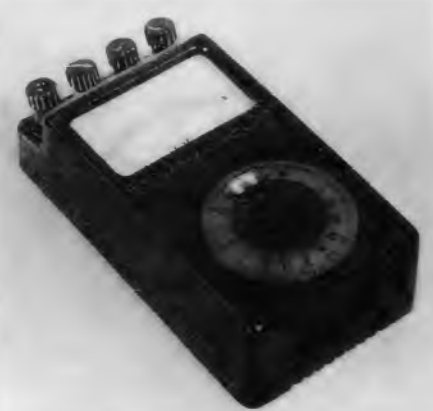
Links: Bild 10. Ontra-Röhrenprüfgerät TRP/4 Oben: Bild 11. AEG-Universalmesser UM mit 32 Bereichen Rechts: Bild 12. Siemens-Einstrahl-Oszillograf „Oszillar I“
