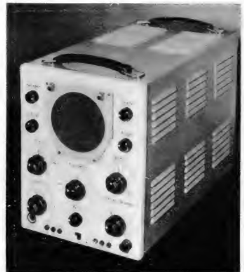
Links: Bild 10. Ontra-Röhrenprüfgerät TRP/4 Oben: Bild 11. AEG-Universalmesser UM mit 32 Bereichen Rechts: Bild 12. Siemens-Einstrahl-Oszillograf „Oszillar I“
