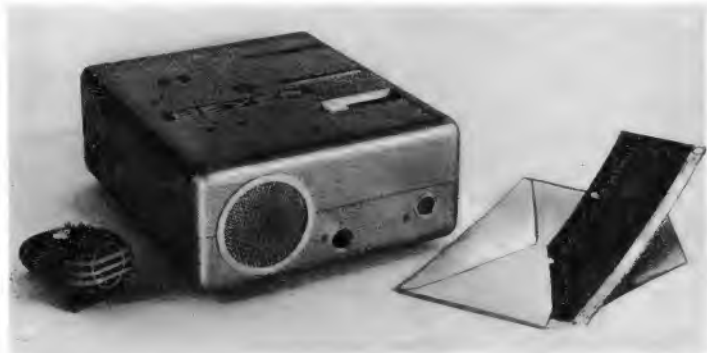
Beyer-Diktiergerät; rechts eine der dafür verwendeten Magnettonfolien
