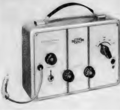
Bild 4. Klirrfaktorbrücke KB 2 des Labor W
