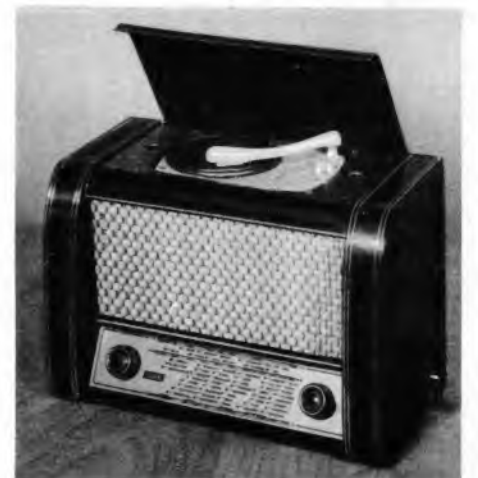
Der kleinste Phonosuper aus deutscher Produktion (Tonjunk „Picophon I“ mit Plattenspieler für 17-cm-Kleinplatten)
