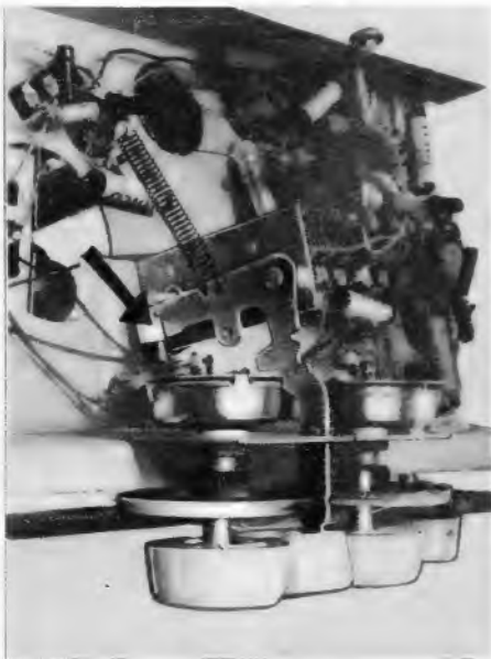
Bild 5. Mechanismus für die Aus-Ein-Taste
