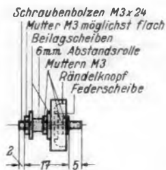
Bild 11. Antriebsachse mit Rändelknopf
