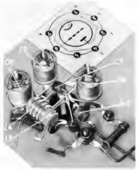
Bild 14. Zweite Baustufe bei der Verdrahtung der Mischröhren-Fassung
