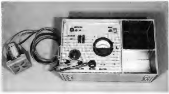
Bild 2. Rotierendes Elektrostatisches Voltmeter nach Prof. Schwenkhagen (Bergischer Feingerätebau)
