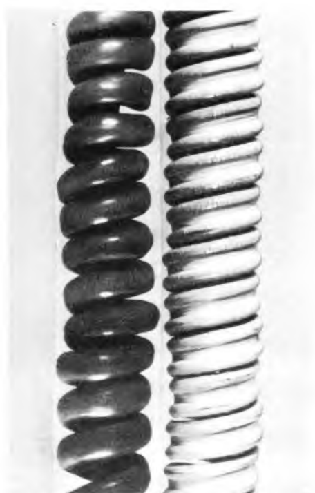
Bild 1. Einwirkung einer stillen Entladung auf eine Siliconkautschukisolation (links) und eine Naturgummiisolation (rechts). Der Naturgummi ist bereits nach 60 Sekunden rissig, während Siliconkautschuk noch nach 60 Minuten völlig unverändert ist
