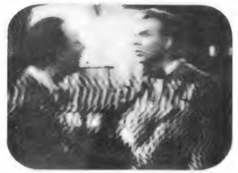
Bild 1. Fernsehstörungen durch ein bewegtes Moirémuster auf dem Bildschirm (Aus der „Fernseh-Bildfehler-Fibel“ von O. P. Herrkind, Radio-Praktiker-Bücherei, Band 51, Franzis-Verlag, München 2)
