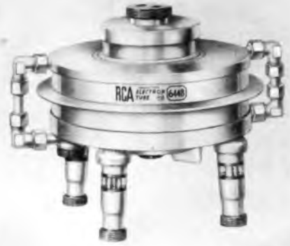
Wassergekühlte Dezimeterwellen-Senderöhre der RCA
