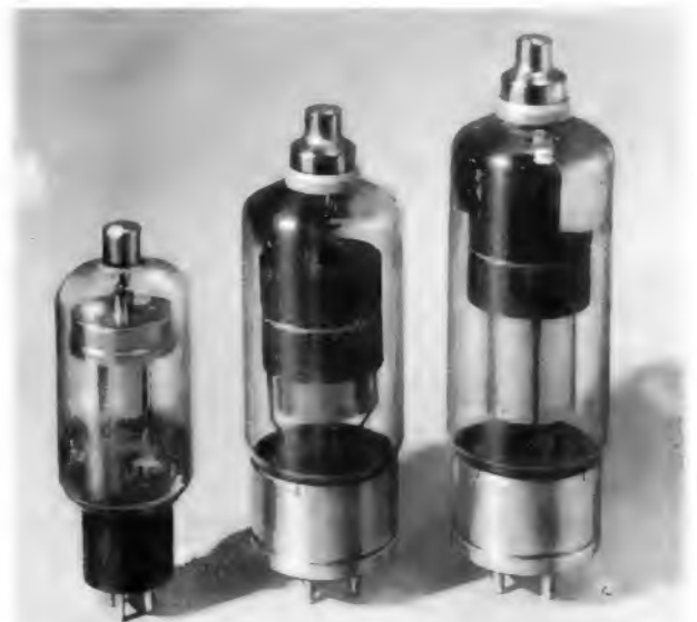
Neue BBC-Röhren mit Gasfüllung. Links der Gleichrichter DX 2, daneben das Thyatron TX 2/3. Rechts das Thyatron TX 2/6. Die Kappenanschlüsse führen zu den Anoden
