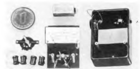
Oben: Bild 2. Die Einzelteile des Kleinst-Instrumentes. Man beachte im Verhältnis dazu die Größe des Pfennigstückes
