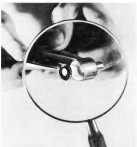
Bild 2. Modell der Atombatterie unter der Lupe (Kolben mit Strontium-90 und Halbleiterschicht)
