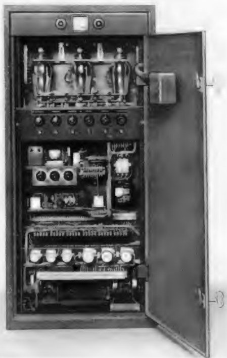
Bild 1. Steuerschrank eines elektronisch geregelten Cotton-Antriebes (Werkbild Siemens)
