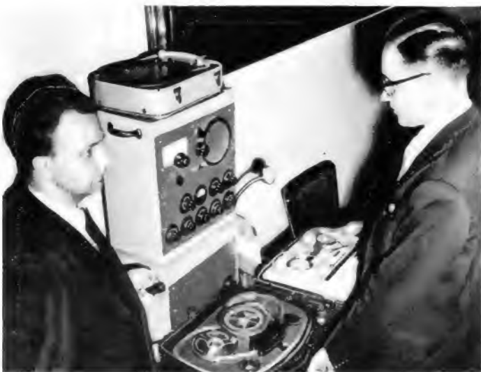
Nach FUNKSCHAU-Konstruktionsseiten gebaute Geräte der „Verstärkerserie 53“ beim Vertonen von Amateurfilmen. Im oberen Gehäus: Rundfunk- und Abhörzersetzen RAZ 52 mit dem Mischpult-Entzerrerverstärker MPV-E 10/7
