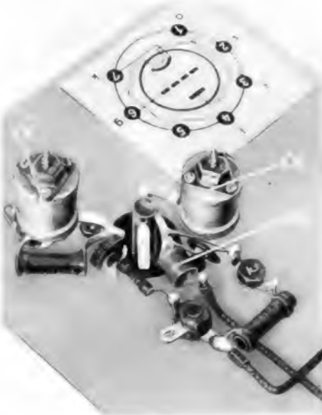
Bild 13. Erste Baustufe bei der Verdrahtung der Mischröhren-Fassung
