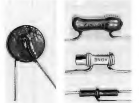
Keramik-Kondensatoren der Elektro-Spezial GmbH; links: Scheibenkondensator mit Drahtanschlüssen; rechts unten: Durchführungskondensator; mitte: Rohrkondensator mit Drahtanschluß (Form Rd); oben: Rohrkondensator mit Kunstharzumhüllung
