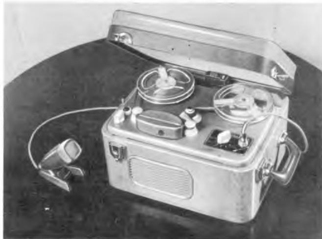
110 / 220 V Wechselstrom. Bandgeschwindigkeit 19 cm/sec. und 9,5 cm/sec.
