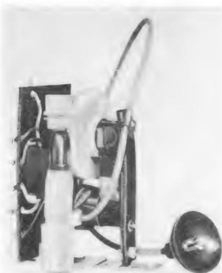
Zeilenausgangstransformator in den neuen Blaupunkt-Fernsehempfängern. Die Hochspannungswicklung ist in Hartwachs eingegossen und die Hochspannungsgleichrichterröhre kann ausgetauscht werden
