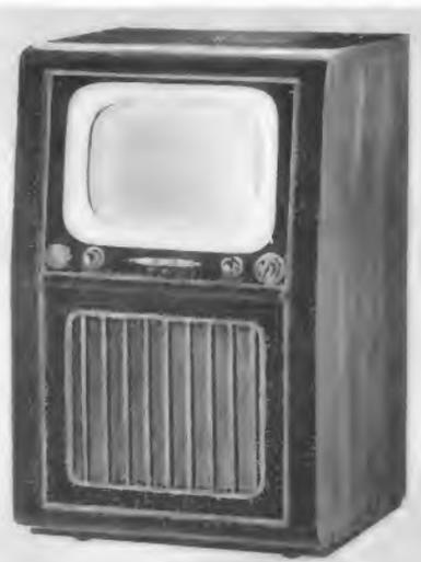
MAGIER 55 mit 43-cm-Bildröhre der Loewe-Opta AG. Das Gerät ist für den Einsatz eines Dezimeterwellen-Converters vorbereitet
