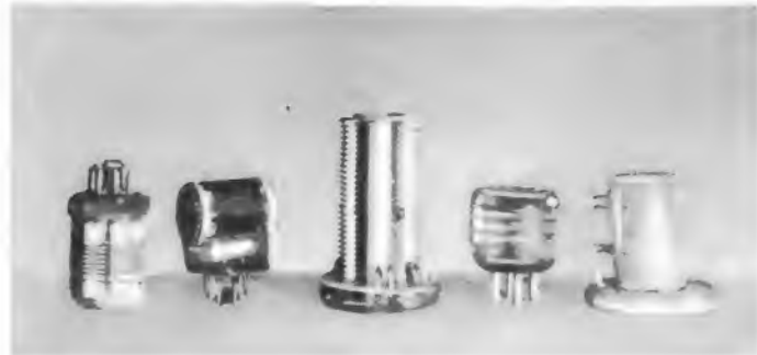
Bild 5. Keramikspulenkörper mit angegossenen Sockeln und eingegossene Spulen
