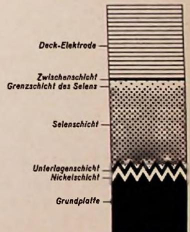
Bild 4. Schematischer Aufbau einer Selengleichrichterplatte
