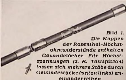
Bild 1. Die Kapfen der Rosenthal-Höchstohm-widerstände enthalten Gewindelöcher. Für Höchstspannungen (z. B. Tastsplitzen) lassen sich mehrere Stäbe durch Gewindestücke (unten links) aneinanderreihen
