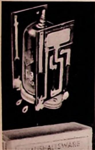
Bild 4. Ausführungsbispiel eines Hf-Generators gemäß Bild 6. Leitungen: Auromal. Widerstände: Grapharol. Kondensatoren: Glimmer mit Auromal-Belägen, nachträglich aufgeklebt. Grundplatten: Hartpapier
