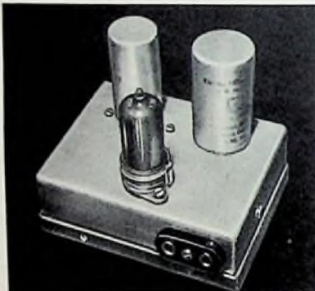
Bild 1. Ansicht des Mischverstärkers mit einer Doppelröhre
