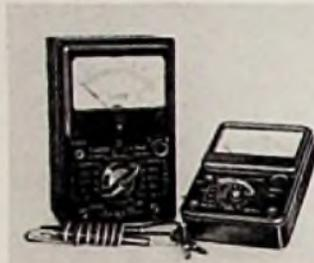
Noch vielseitiger ist das links im Bild dargestellte Meßgerät UF 260. Es besitzt sechs Spannungsmeßbereiche bis 10/50/250/500/1000/5000 V, und zwar jeweils für Gleich- und für Wechselspannung. Dabei werden nur 150  $\mu$ A für den vollen Skalausschlag benötigt. Die vier Gleichstrombereiche reichen bis 0,25/10/100/500 mA. Vier Widerstandsmeßbereiche bis 1/10/100 k $\Omega$  und 1 M $\Omega$  erlauben die sichere Überprüfung der meist gebrauchten R-Werte. Preis: 99,50 DM.
