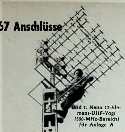
Bild 1. Neun 11-Element-UHF-Yagi (500-MHz-Bereich) für Anlage A
