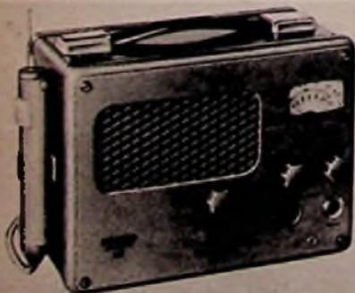
Bild 4. Signalverfolger SV 1 mit angestecktem Tastkopf
