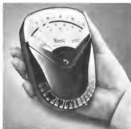
Bild 13. Monoc-Vielfachmesser in „handlicher“ Form von Chauvin-Arnoux
