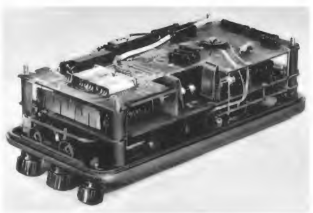
Bild 8. Mechanischer Aufbau mit gedruckten Leiterplatten
