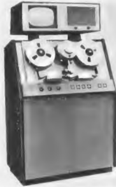
Neue „billige“ Ampex-Videoaufzeichnungsanlage Modell VR-8000 für das industrielle und Erziehungsfernsehen; Bandgeschwindigkeit 19 cm/sec, Aufzeichnungszeit 2 Stunden
