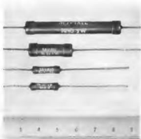
Bild 1. Metall-oxidfilm-Widerstände auf Glaskörpern von der Firma Sovirel. Darstellung in halber natürlicher Größe; von oben nach unten: 2-W-Widerstand, 1-W-Ausführung und zwei 0,5-W-Typen
