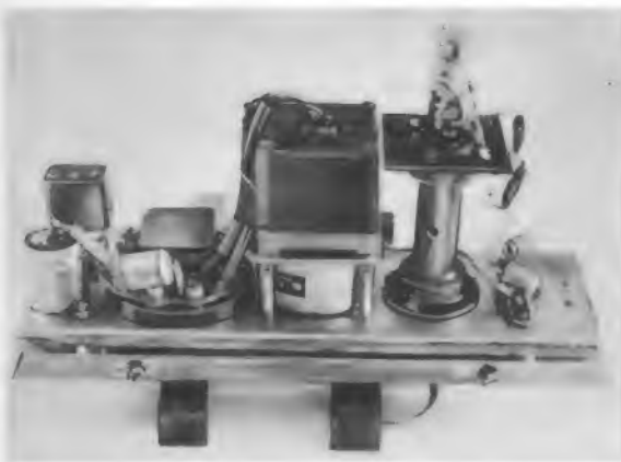
Bild 6. Der zusammengebaute Rotor: In der Mitte der Motor, rechts davon die Antennenlagerung mit dem Spulenkörper und den in sich drehbaren Wicklungen des Antennenübertragers, links die beiden Relais und der Motorkondensator
