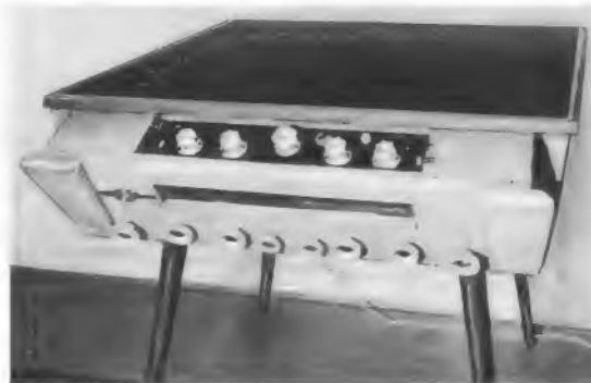
Unten Bild 2. Verstärkertisch, Bedienelemente für Mischpult und Stereoverstärker herausgeklappt
