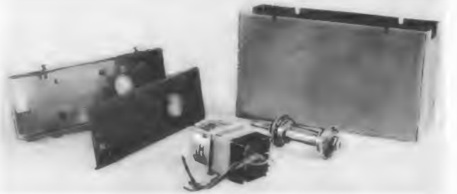
Bild 3. Die mechanischen Einzelteile: Deckplatte, Chassisplatte und das zusammenschraubte Gehäuse. Vorn der Motor und die Fahrradnabe mit der neuen Achse
