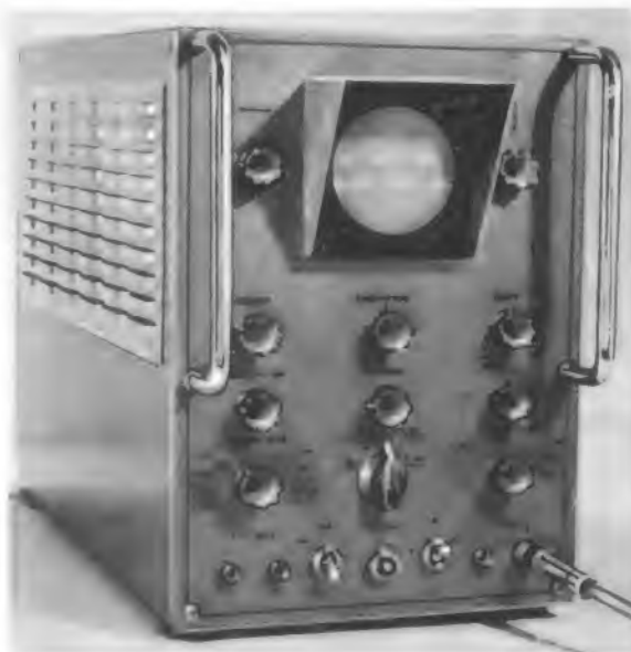
Bild 8. Das fertige Gerät von vorn gesehen. Auf dem Bildschirm wird ein 400-Hz-Rechteck-Signal geschrieben
