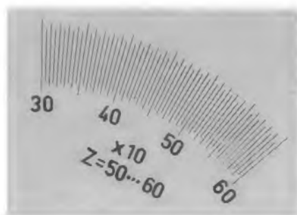
Bild 24. Muster einer Eichskala. Diese ist verwendbar für Zeigerlängen zwischen 50 und 60 mm. Wenn Agfa-Correctostat-Rapid-Papier dafür verwendet wird, ist sie selbsttragend
