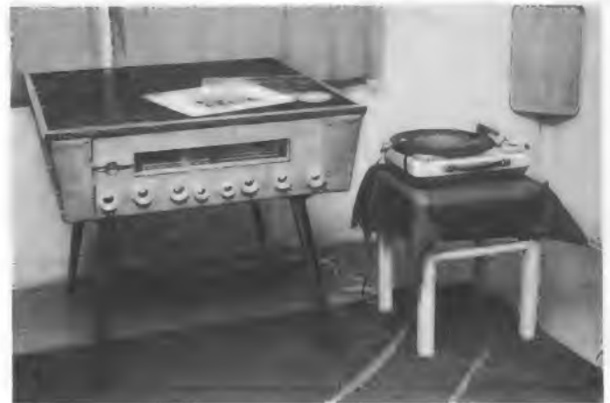
Unten Bild 2. Verstärkertisch, Bedienelemente für Mischpult und Stereoverstärker herausgeklappt
