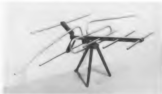
Die Defra-Fernseh-Tischantenne Typ KF 3/4. Sie besteht aus einem UHF-Yagi mit sechs Elementen und einem gestreckten Dipol für VHF
