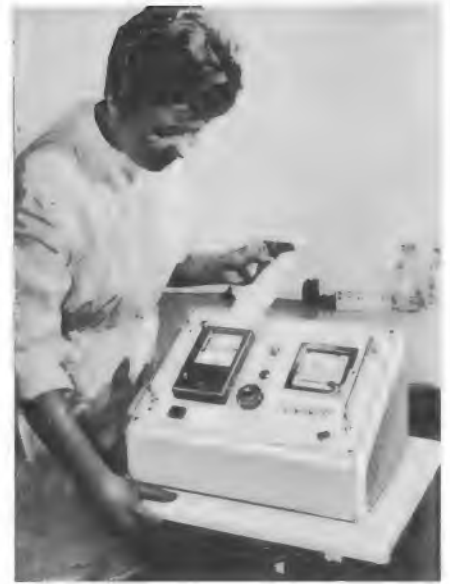
Bild 2. Pultförmiger Empfänger für die Heidelberger Kapsel mit Wachspapierschreiber, Zeigerinstrument und Bedienungsorganen
