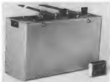
Bild 7. Das geschlossene Gehäuse mit den Halterwinkeln und dem Achsstummel zum Befestigen des Antennenmastes
