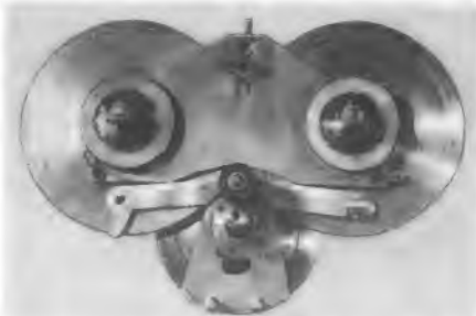
Bild 21. Spur-Umschalthebel, Schrägungsscheibe mit Tonrolle, Andruckrollenhebel mit Andruckrolle und Bandtellerantrieb zusammengesetzt
