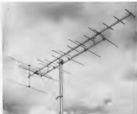
Eine ungewöhnliche Form zeigt die Hirschmann-Antenne Fesa 23 OLH. Die Direktoren für den Bereich III sind unterhalb der Empfangsebene des Bereiches IV angeordnet
