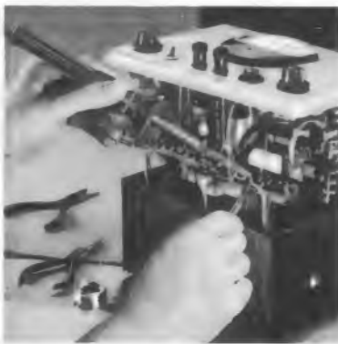
Ein sehr bewährter LötKolben, der Typ Ers. 30, beim Gebrauch in der Meßgeräte-Industrie
