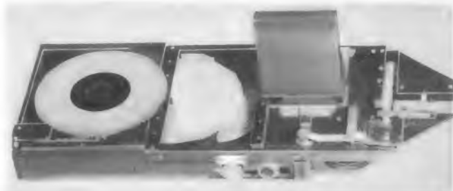
Bild 3. Die Ansicht des fertigen Gerätes. Links die flache, lichtdichte Kassette mit der Skalenscheibe und dem Antrieb für das Vergrößerungspapier. Die Kassette ist gerade geöffnet, man sieht ein Stück Vergrößerungspapier auf dem zugleich als Aufspanntisch dienenden großen Zahnrad. Das hochstehende Gehäuse enthält die Belichtungseinrichtung. Die rechts befindliche Gesamtanordnung stellt den Kassettenschieber dar. Ist er nach links geschoben, dann ist die Kassette geschlossen und der Lichtschlitz mit der darüber befindlichen Belichtungseinrichtung befindet sich über dem Vergrößerungspapier. Vorn in der Mitte ist der Zeitstellknopf sichtbar, der auf einer Potentiometerachse sitzt, rechts daneben die Betriebsanzeigelampe und noch weiter rechts die Auslösetaste
