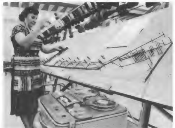
Nach der Ansage des Magnetophongerätes wird der Kabelbaum gelegt
