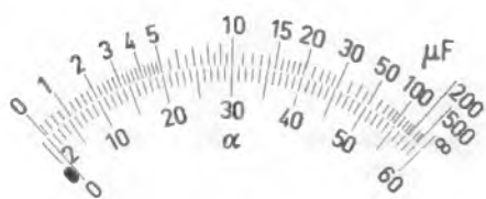
Bild 1. Diese Skalenteilung wurde mit dem hier beschriebenen Foto-Teilgerät angefertigt
