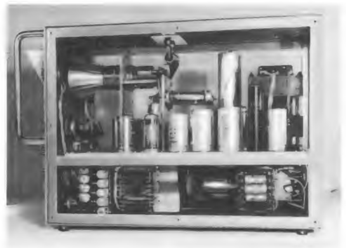
Bild 6. Linke Seitenwand abgenommen, links unter der Grundplatte der Eingangsschwächer mit den auf eine Pertinaxplatte montierten Trimmern C 1...C 10, rechts daneben alle Bauelemente der ersten Gegentaktstufe R 6 1 und R 6 2
