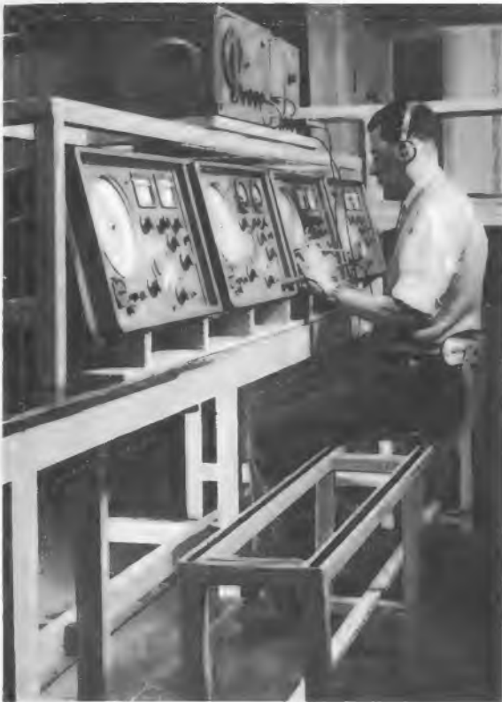
Arbeitsstudien in der St.-Albans-Fabrik von Marconi Instruments Ltd. haben zu dieser wirksameren Anordnung geführt, um vier Frequenzgeneratoren gleichzeitig sichten zu können. Das Prüfgerät ist auf einem Schiebegerüst angebracht. Der Techniker sitzt auf einem Gleitsitz, und die Frequenzgeneratoren sind so geneigt, daß die Bedienungsschalter leicht zugänglich sind
