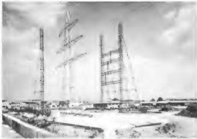
Oben: Bild 2. Vom Meßhaus der BBC-Prüfstation für Sendetürme und Hochspannungsmaste können das Prüfobjekt beobachtet und die Seilwinden fernbedient werden
