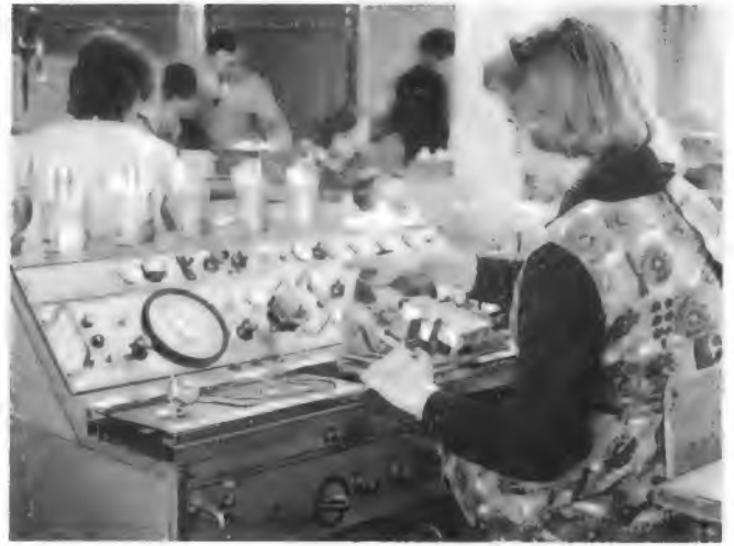
An diesem Arbeitsplatz im Ingolstädter Werk der NSF werden von geschickten Frauenhänden die elektrischen Betriebsmerkmale der UHF-Tuner eingestellt
