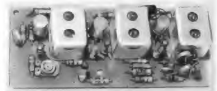
Bild 4. Printplatte des Zf-Verstärkers von der Bestückungsseite gesehen
