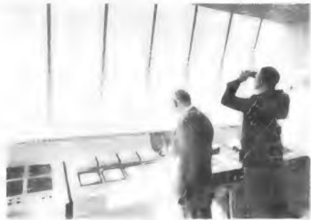
Oben: Bild 2. Vom Meßhaus der BBC-Prüfstation für Sendetürme und Hochspannungsmaste können das Prüfobjekt beobachtet und die Seilwinden fernbedient werden
