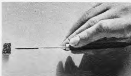
Bild 6. Mit der „Löt-nadel“ Ersam-minor lassen sich Feinstlötungen an Miniaturbauteilen ausführen
