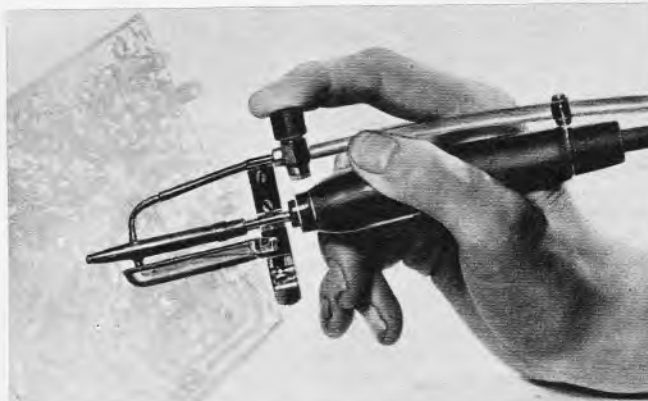
Bild 5. Ablötwerkzeug der englischen Firma Antex. Es benötigt einen Druckluftanschluß zum Absaugen des flüssigen Zinns
