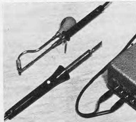
Bild 2. LötKolben mit der neuen Wendelspitze. Dahinter das Entlötwerkzeug Typ Pico-fit von Lötring mit Niederspannungstransformator (rechts)
