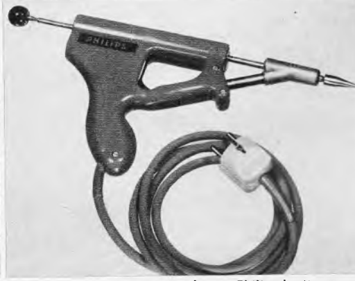
Bild 4. Die Vakuum-Lötpistole von Philips besitzt eine zylindrische Saugkammer mit einem eingepaßten Kolben. Das Werkzeug ist für 220-V-Betrieb vorgesehen und verbraucht 35 W
