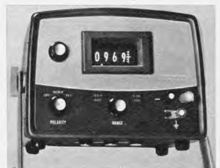
Digital-Voltmeter der Serie Digitec mit vier Meßbereichen und einer höchsten meßbaren Spannung von 1000 V
