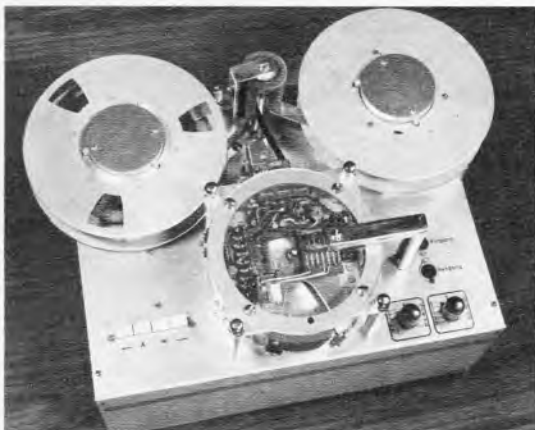
Links: Bild 1. Die vierte Version des von Herbert Pöhler entwickelten Videoaufzeichnungsgerätes. Das Chassis hat eine Gesamthöhe von nur 238 mm
