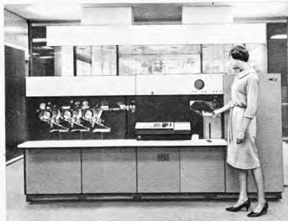
Bild 1. Der Mehrfunktions-Belegleser IBM 1287. Links Ablagefächer, in die die verarbeiteten Belege nach verschiedenen Gesichtspunkten programmgesteuert abgelegt werden; in der Mitte das Steuerpult und darüber der runde Bildschirm für die visuelle Prüfung von Zeichen, die die Maschine nicht erkennen kann
