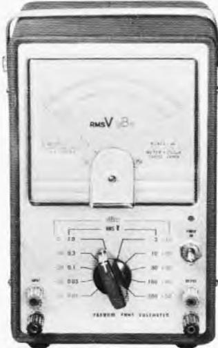
**Millivolt-Röhrenvoltmeter HRV 260**
