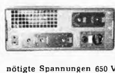
**Gegentakt-Endstufe** im Bereich von 160 MHz leicht auf 2 m abzuändern. **Technische Daten:** HF-Ausg.-Leistg. 80 W an 60 Ω, benötigte Ansteuerleistg. 12 W für Vollaussteuerung. **Be-**
