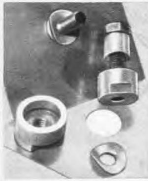
In 1 1/2 Min. werden in dem Rekordlocher einwandfreie Löcher in Metall und alle Materialien gestanzt. Leichte Handhabung - nur mit gewöhnlichem Schraubenschlüssel. Standardgrößen von 10-65 mm Ø, von DM 11,- bis DM 58.30
