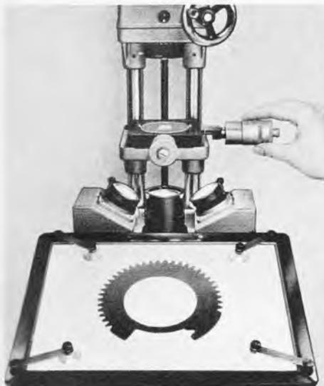
geschieht unter anderem durch zwei der oben abgebildeten Zahnscheiben. Sie befinden sich an der Tunerachse. Die einwandfreie Qualität wird bestimmt durch genaue Einhaltung der vorgeschriebenen engen Toleranzgrenzen. Deshalb ist es wichtig, auch die im Werkeintreffenden Zahnscheiben sorgfältig zu prüfen. Das geschieht bei Graetz durch einen Profilprojektor in einem Vergrößerungsmaßstab von 1:10. Selbstverständlich werden auch alle anderen Einzel-
