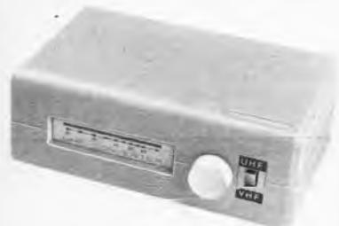
zum Empfang des 2. und 3. Fernsehprogramms mit hoher Verstärkung und kleiner Rauschzahl
