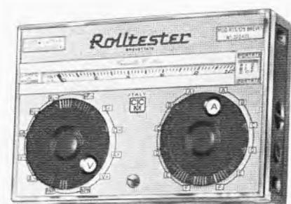
von 0—40 µA bis 400 mA und 3,5/20/200 A mit Shunts, Wechselstrom von 0—4 A und bis 240 A, Ohmmessung von 0,1—10 meg/ohm. Ferner Kapazitätswertmessungen, indukt. Blindwiderstandsmessungen, Frequenzmessungen, dB-Messungen, Transistor-Prüfungen, Temperatur- u. Lux-Messungen. Abmessungen 100 x 150 x 45 mm.
