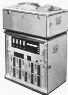
1", Mehrspurapparat (4 bis 8 Spuren), umstellbar, jetzt auch volltransistorisiert mit runderfunkeproblem Verstärker.
