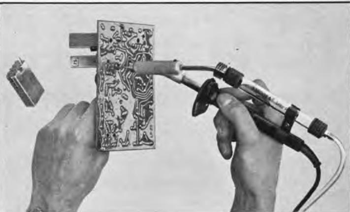
Bauteile entfernt man aus gedruckten Schaltungen ohne mechanische und thermische Schäden mit dem
