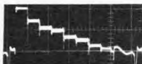
Bild 15. Leuchtdichtesignal des 75-%-Farbbalkens am Eingang der RGB-Matrix
