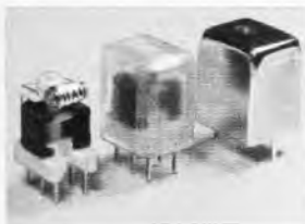
Links: Bild 1. Bausatz D 41-2393 von Vogt & Co. mit montiertem Kreiskondensator in natürlicher Größe
