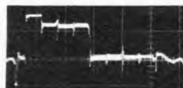
Bild 16b. Grünsignal am Ausgang des Grün-Matrixtransistors
