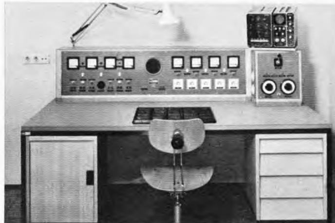
Bild 2. Übersichtlicher Aufbau eines Meß- und Prüftisches. Die Instrumente dieses Waldner-Tisches können nach den Erfordernissen zusammengestellt werden. Obwohl die Meßausstattung nicht die gleiche ist, sei sie hier dem Bild 1 gegenübergestellt.
