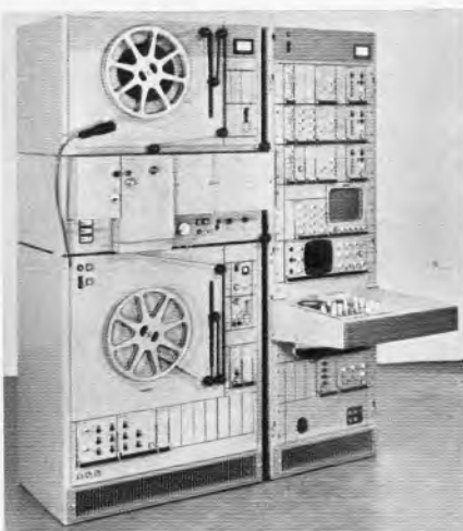
Bild 2. 16-mm-Farbfilm-Übertragungsanlage. Links Filmprojektorschrank; rechts Verstärkerschrank mit Bedienpult (Werkaufnahme: Fernseh GmbH)
