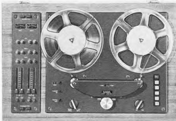
Bild 1. Draufsicht auf die Platine und das Mischpult des Stereo-Tonbandgerätes 600 SH
