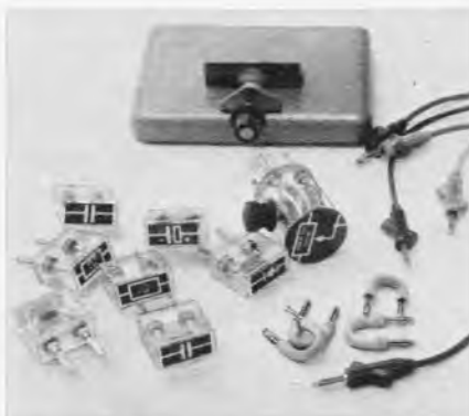
Bild 2. Zubehör zu den Didacta-Lehrplatten: Widerstände, Kondensatoren und Dioden in steckbaren Gehäusen, Verbindungsstecker und Schnüre und im Hintergrund eine Sockelplatte zum Aufstellen der Lehrplatten
