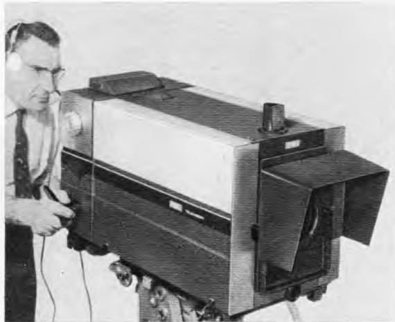
Die neue Farbfernsehkamera EMI 2001 mit Vario-Optik im Gehäuse und einem äußerst lichtstarken optischen System. Die Kamera arbeitet mit vier Plumbikon-Aufnahmeröhren
