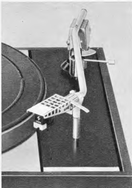
Bild 6. Die Schutzkappe über der Tonabnehmerkapsel des Thorens-Plattenspielers ist perforiert, um das Gewicht weitgehend zu verringern
