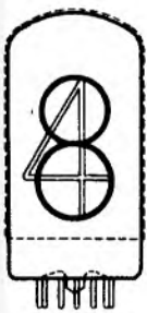
Bild 1. Ziffernanzeigeröhre mit Leserichtung parallel zur Röhrenachse
