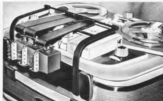
Bild 9. Versuchsanordnung der Zugmagnete zur automatischen Tastenbetätigung
