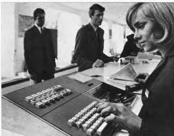
Bild 2. Buchungsplatz mit Bedienungs- und Anzeigenteil. Oben links ein Feld mit Leuchttasten zum Eingeben bestimmter Daten und Befehle. Unten links befindet sich die Fernschreibtastatur und oben rechts der Adapter für die Flugplankarten. Unten rechts ist die Ablage der Flugplankarten und ein Leuchtziffernfeld, auf der ein Teil des Buchungstelegramms zur Kontrolle erscheint, erkennbar
