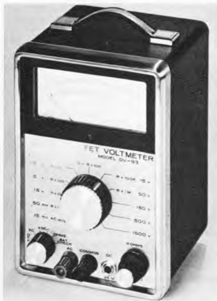
Das FET-Voltmeter, Modell DV-93, hat in den Gleichspannungsbereichen einen Eingangswiderstand von 26 \text{ M}\Omega und in den Wechselspannungsbereichen eine Eingangsimpedanz von 1 \text{ M}\Omega/40 \text{ pF}
