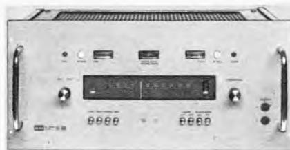
Bild 2. Vorderansicht des Gerätes. Das Einschubgehäuse entspricht DIN 41 490
