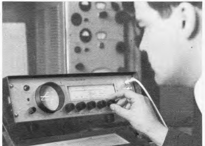
Bild 5. Batteriebetriebenes Antennenspannungs-Meßgerät 8121 von Kathrein
