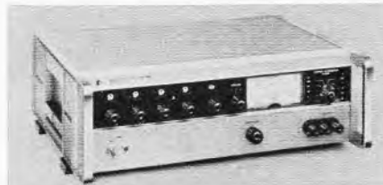
Bild 7. Digital auf vier Stellen genau einstellbarer Oszillator für 10 Hz bis 1 MHz von Hewlett-Packard
