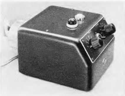
Bild 4. Ansicht des Zeitgebers. Auf der schrägen Vorderfläche befinden sich die Zeiteinstellskalen und der Netzschalter, oben sitzen die Signallampe und die Auslösetaste, hinten die Netzsteckdose für das Vergrößerungsgerät
