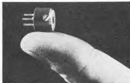
Oben: Bild 1. Miniaturpotentiometer mit 12 mm Durchmesser und Markierung zur Anzeige der Schleiferstellung ( TWK-Elektronik )
